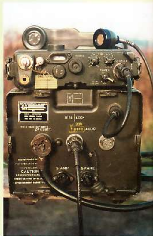
De RT-176A/PRC-10 in een amplifier-power supply type AM-598/U met telemike
